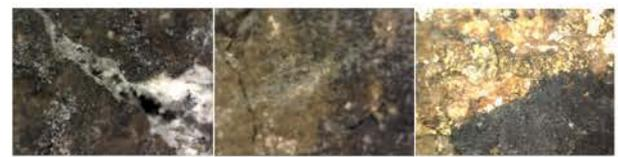
Cristallizzazione dei sali all'interno della matrice con formazione di microfratture.
