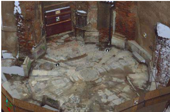
Nuvola di punti tridimensionale da Laser Scanner
